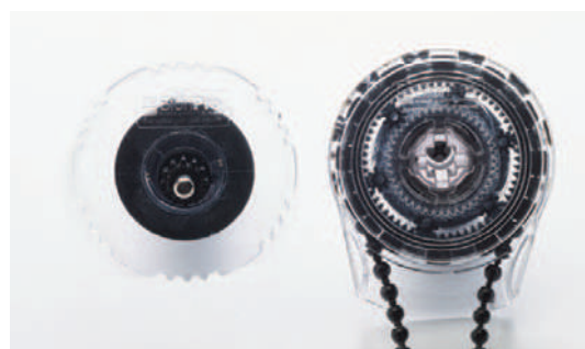
Embrayage démultiplié avec avec fin de course basse, rapport 2,5 : 1
